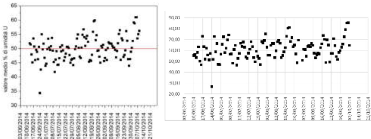
Fig. 10 Valori medi giornalieri in % registrati nel 2014, all'interno della sala (a sx) e all'esterno dell'edificio (a dx)
