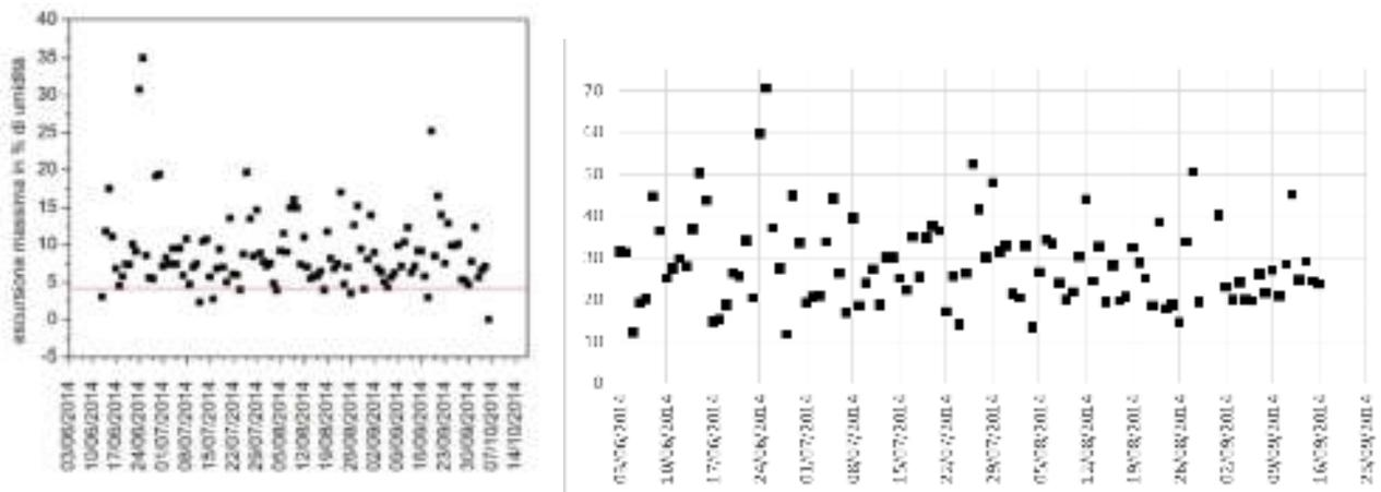
Fig. 9 Escursioni massime giornaliere in % verificatesi nel 2014, all'interno della sala (a sx) e all'esterno dell'edificio (a dx)
