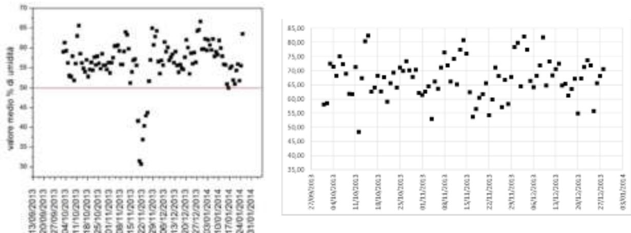
Fig. 6 Valori medi giornalieri in % registrati nel 2013, all'interno della sala (a sx) e all'esterno dell'edificio (a dx)
