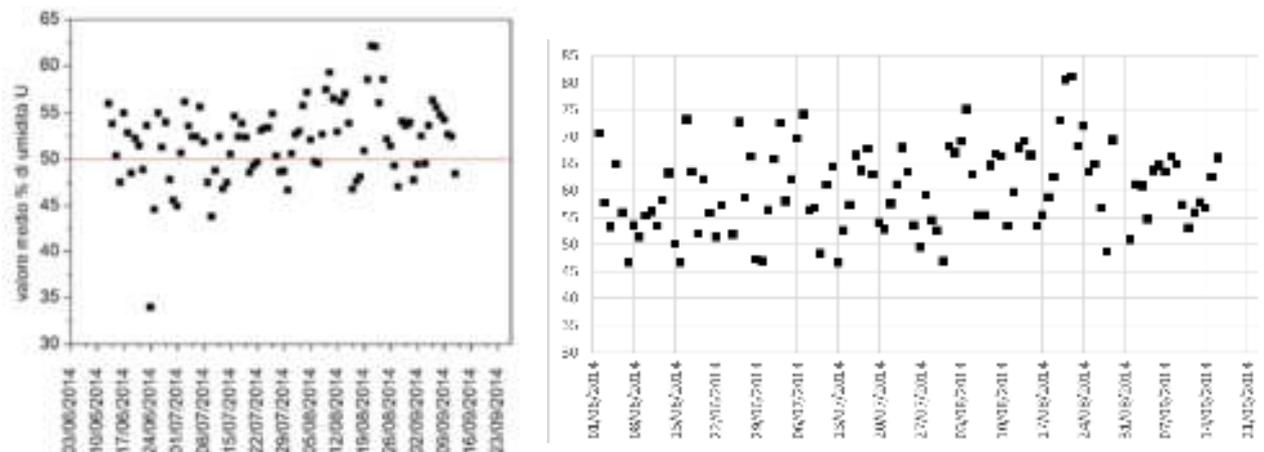
Fig. 9 Valori medi giornalieri in % registrati nel 2014, all'interno della sala (a sx) e all'esterno dell'edificio (a dx)
